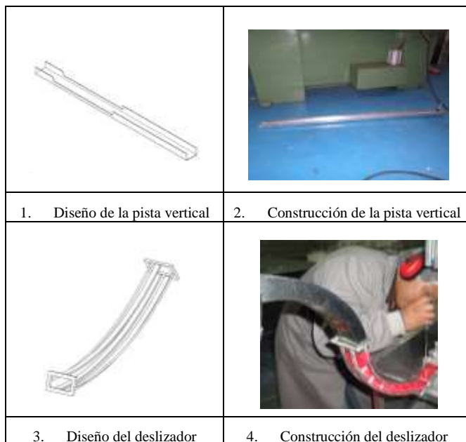
Figura 19: Construcción del subsistema de alimentación
