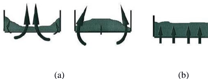
Figura. 1.11 Distribución del producto a secar no deseada (a), condiciones de alimentación del producto aceptables para el secado uniforme (b).
