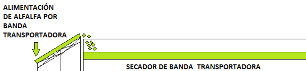
Figura 3.2 Diagrama de la alimentación por banda transportadora al secador de banda.
