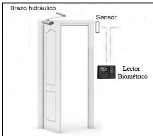
Figura 12. Sistema de control de acceso al Data Center.
