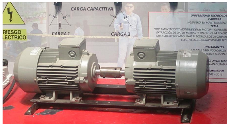
Figura 4.2 Motores de inducción acoplados
