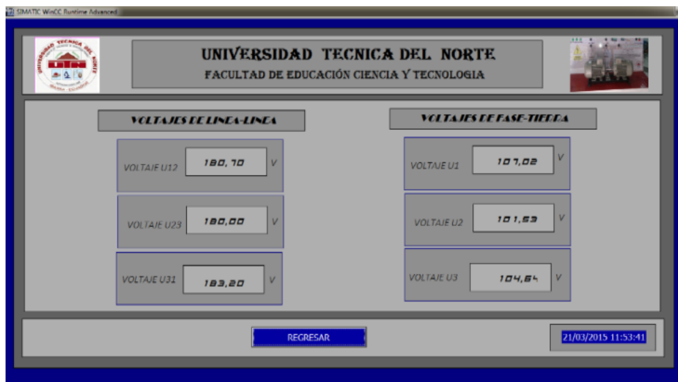
Figura 4.44 Vista de monitoreo de voltajes
