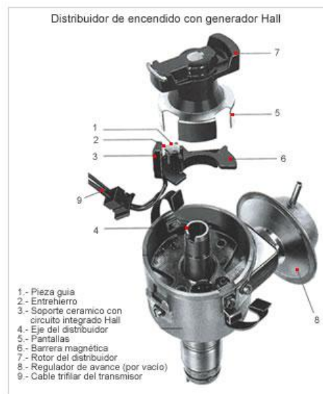
Fig.Nº52 Distribuidor de encendido electrónico.
