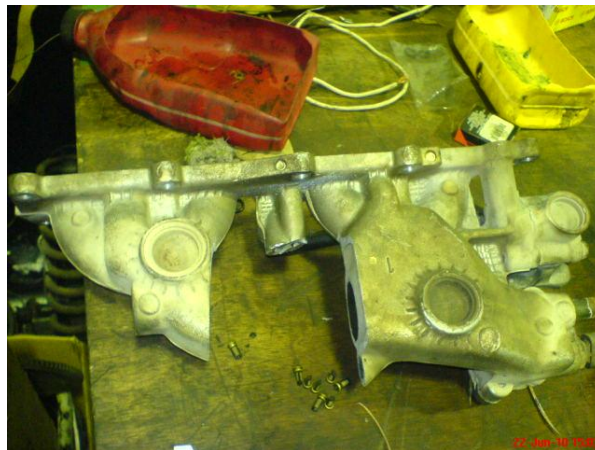
Fig.Nº62. Corte del múltiple de admisión.
