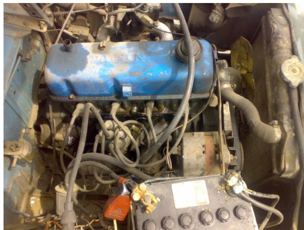
Fig.Nº56 Verificación de cables y distribuidor de encendido
