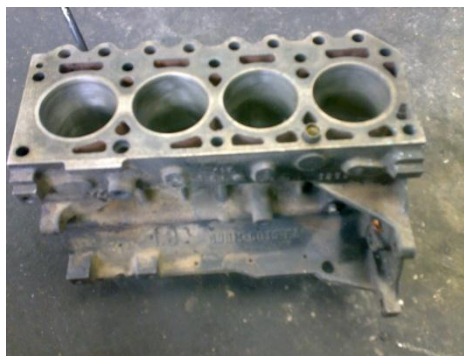
Fig.Nº58. Bloque de cilindros en mal estado
