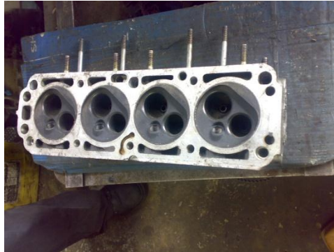
Fig.Nº57. Comprobación de cabezote.
