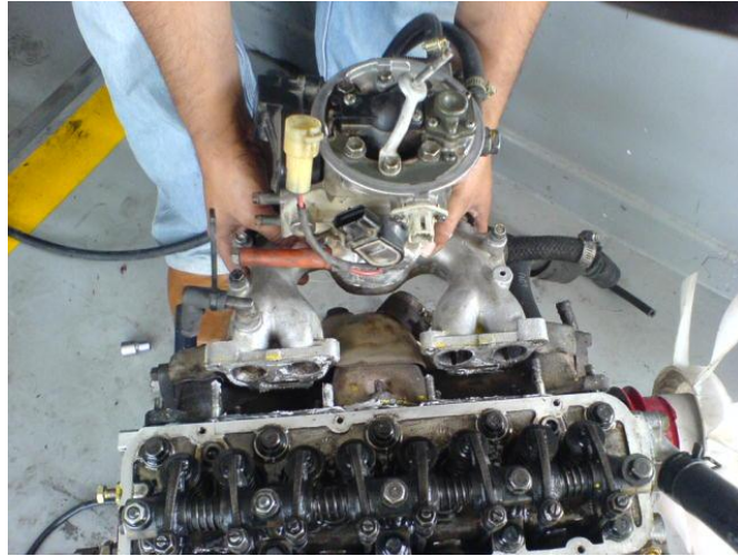
Fig.Nº63. Montaje del múltiple con el inyector.
