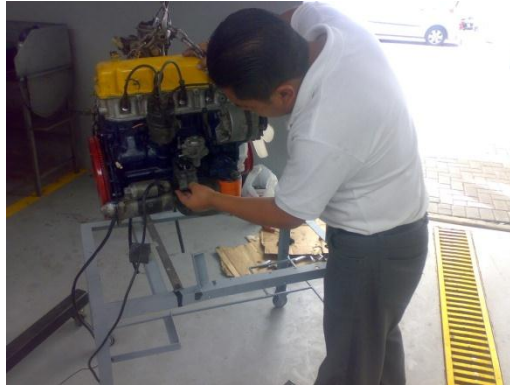
Fig.Nº66. Montaje del motor.
