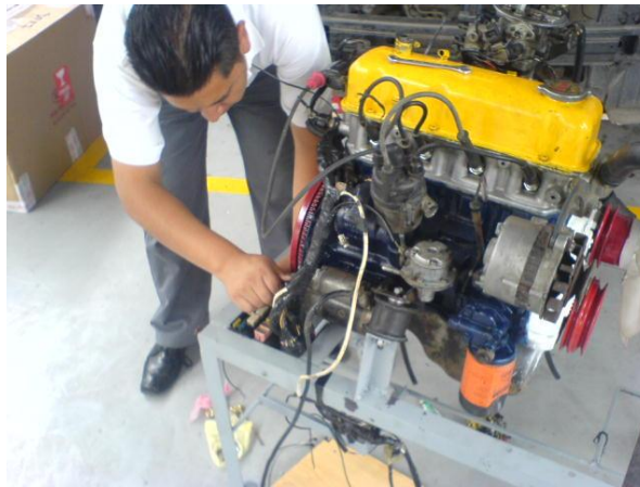
Fig.Nº75 Instalación partes eléctricas
