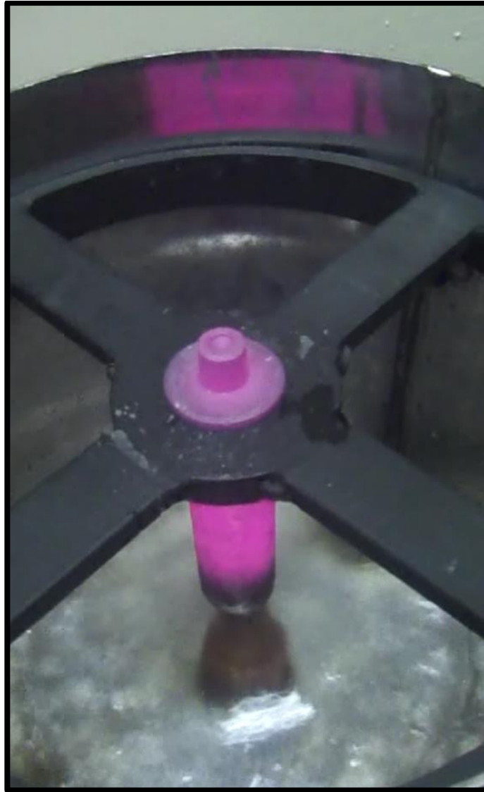
FIGURA 48: Película de agua en forma de hongo concéntrico
