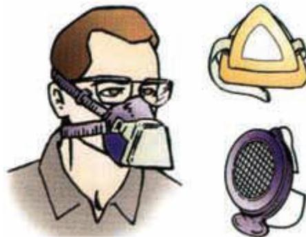
**Figura 7.- Respiradores con filtro mecánico**
