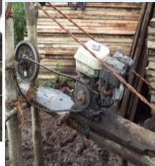
Acoplamiento del motor de luz eléctrica al sistema del cable
