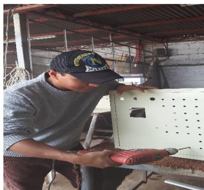
*Figura 101* Perforación del gabinete metálico
