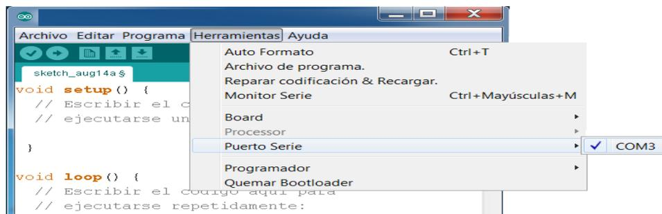
**Figura 77** Pasos conexión Arduino-Pc.
