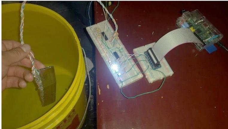
Figura 15. Prueba de funcionamiento del circuito de sensor de nivel de agua
