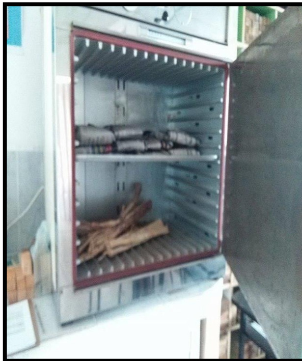
Anexo 5.12 Secado de muestras en la estufa.
