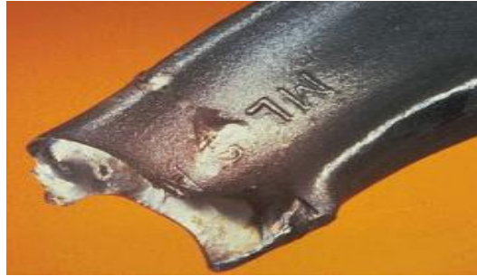
Figura 8. Corte por impacto.
