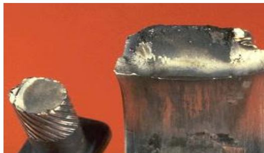
Figura 13. Falla por pernos rotos o flojos.
