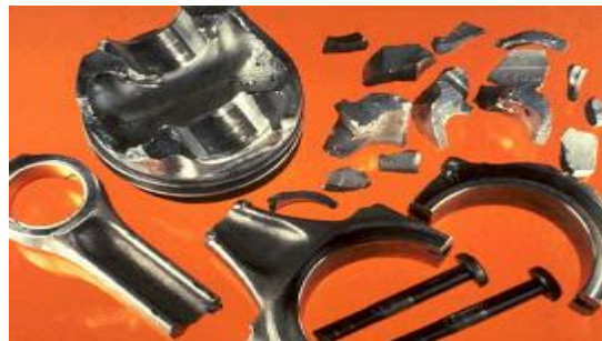
Figura 10. Falla de bielas.
