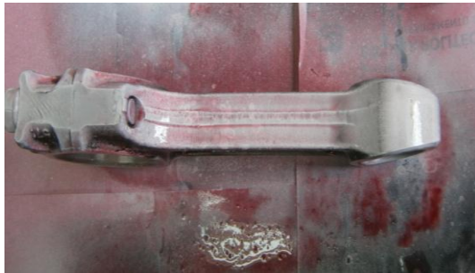
Figura 57. Biela con partículas magnéticas.
