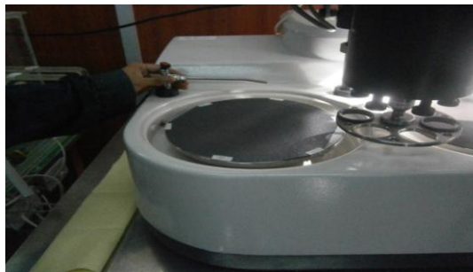
Figura 39. Preparación de la máquina y lijas para el pulido de las probetas.
