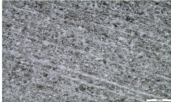
Figura 42. Micrografía a 100x biela original.
