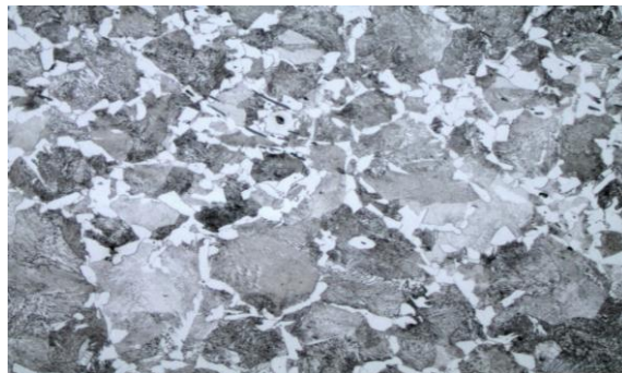
Figura 43. Micrografía a 500x biela original.
