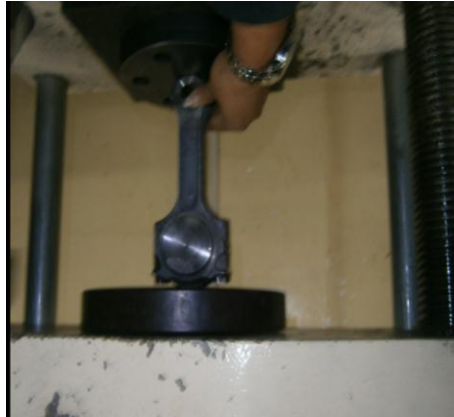
Figura 60. Ubicación de la biela en la máquina de ensayos universales.
