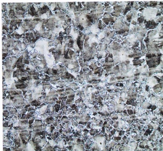
Fotografía N° 3. Muestra de biela alterna, se observan bandas de alineadas en dirección del conformado y una microestructura de tipo ferrítico-perlítica. 100X
