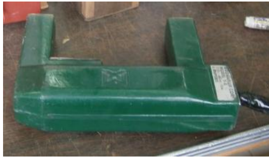
Figura 54. Yugo para crear el campo magnético.
