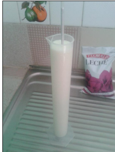
Ilustración A2.- Medición de la densidad
