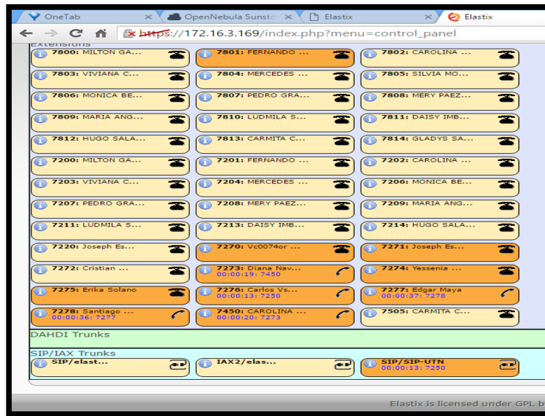
Figura 73. Llamada entre usuarios a nivel local Referencia: Elaboración propia servidor Elastix PBX-FICA
