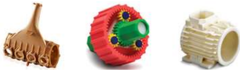
Figura 1.17 Impresión con tecnología FDM (Stratasys Ltd, 2017)
