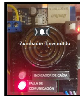
Figura 12: Alarma de falla de comunicación auditiva y visual.
