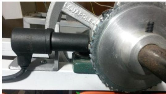
Al girar el reluctor a una determinada velocidad, el paso de los dientes del reluctor deforman el campo magnético de un imán permanente que se encuentra en el interior del sensor, este cambio en el campo induce un voltaje en la bobina que se encuentra acoplada alrededor del
