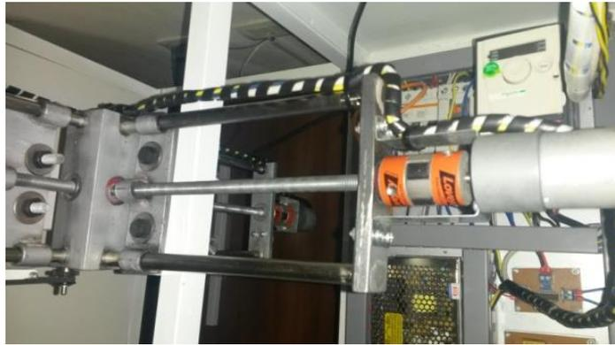
Como se menciona anteriormente, la velocidad a la que se desplazan estos mecanismos depende únicamente de la reducción de velocidad creada por la caja de reducción a la salida del motor y el paso de rosca de la varilla.
