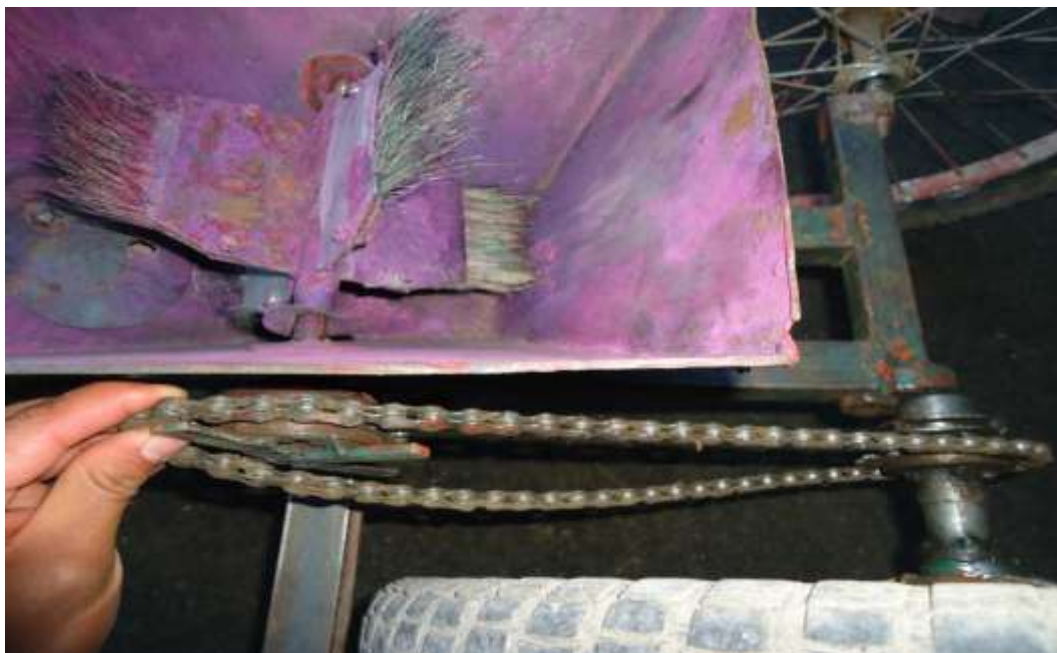
Figura 57: Tren cinemático y órgano de distribución
