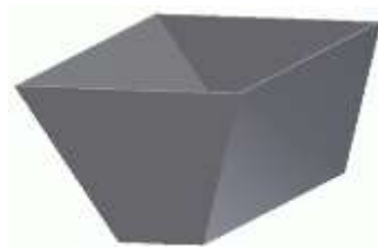
Figura 35: Geometría de la tolva en CAD Inventor Professional
