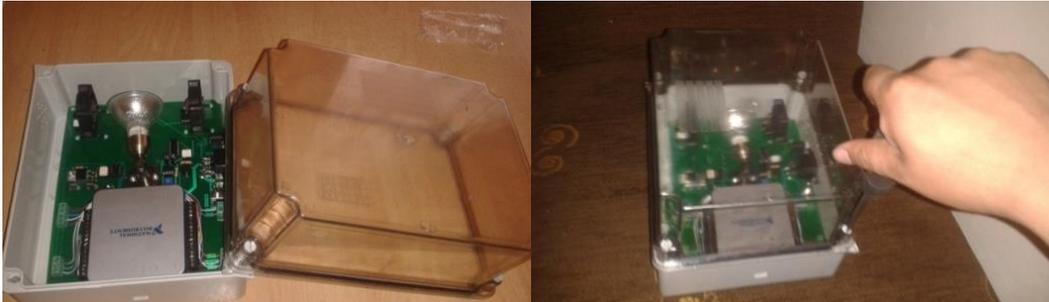
**ILUSTRACIÓN 58:** Sellado del módulo
