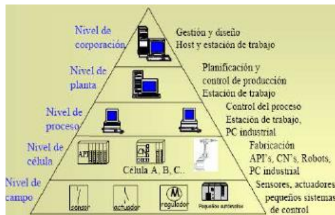
FIGURA 6: Estructura jerárquica de la automatización, Pozo Gutiérrez, 2010
