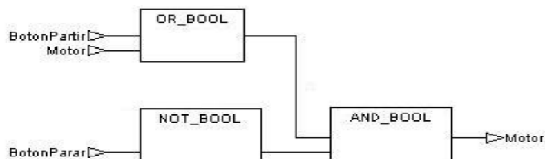
FIGURA 9: Function Block Diagram programación, introducción a la programación
