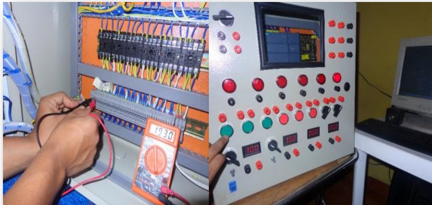
FIGURA 23: Pruebas de funcionamiento del tablero "Elaboración propia"
