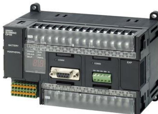
FIGURA 2: Controlador programable compacto, https://industrial.omron.es
