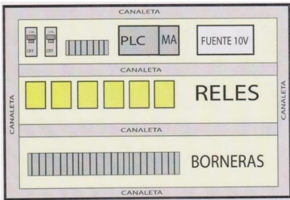
Fig. 20 Diseño de vista interior del módulo con PLC
