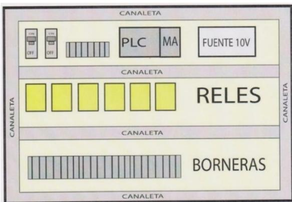
Fig. 8 Diseño de vista interior del módulo con PLC
