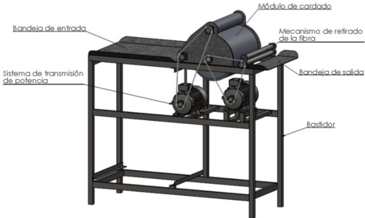
Figura 3.1. Diseño de prototipo de máquina cardadora de fibras largas
