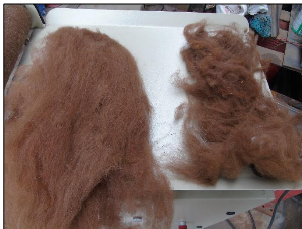
Figura 3.51. Comparación de fibra antes y después del cardado
