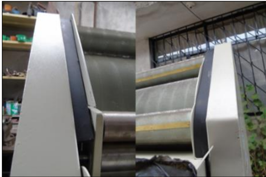
Figura 3.36. Esponja rígida colocada entre el protector del sistema de transmisión y el soporte lateral
