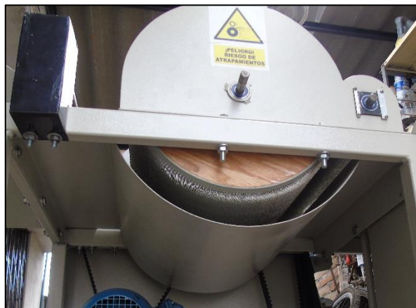
Figura 3.34. Protección para los motores
