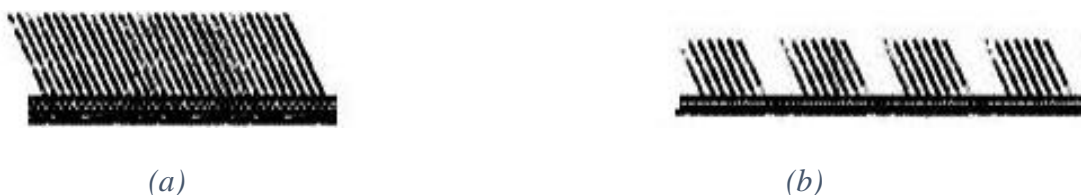
Figura 1.6. Guarniciones de diferentes alturas y distancia entre secciones (a) guarnición usada para el proceso de emborrado, (b) guarnición usada para el proceso de mecheado [7]
