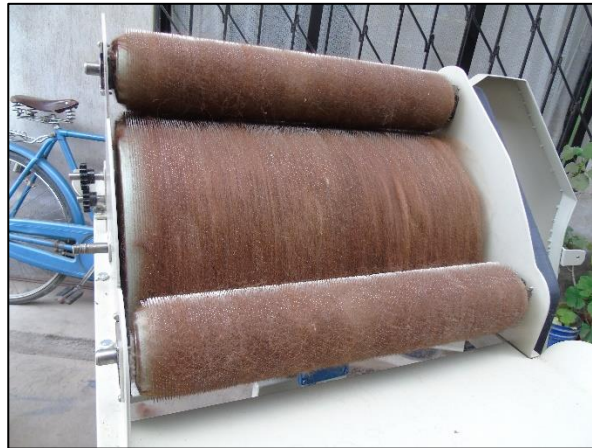
Figura 3.47. Fibra cardada en el rodillo transportador
