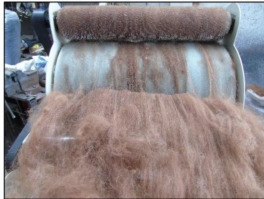
Figura 3.49. Fibra siendo retirada del rodillo transportador
