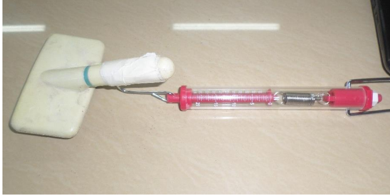
Figura 3.7. Newtómetro unido a cepillo con guarnición flexible.
