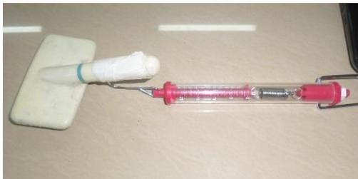
Figura 5 Newtómetro unido a cepillo con guarnición flexible.
