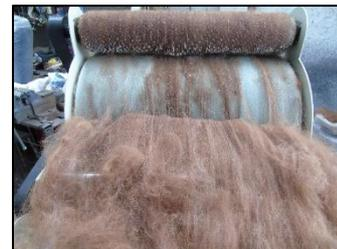
Figura 22 Fibra siendo retirada del rodillo transportador
