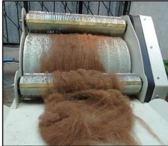
Figura 19 Introducción de fibra en la cardadora.
