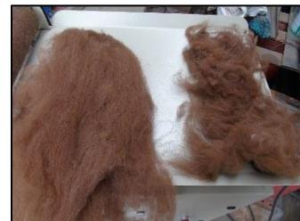
Figura 24 Comparación de fibra antes y después del cardado
