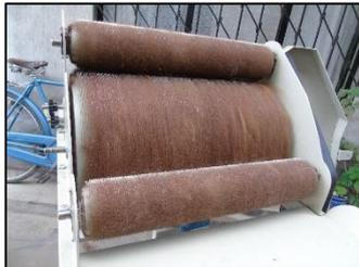
Figura 20 Fibra cardada en el rodillo transportador
