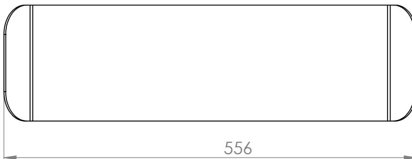
NOTA: Espesor de la chapa de 3.3 mm
