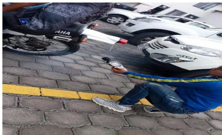
Figura 5.26. Medición tubo de escape motocicleta Yamaha
