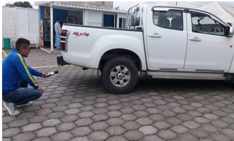
Figura 5.28. Medición tubo de escape Chevrolet D-max
