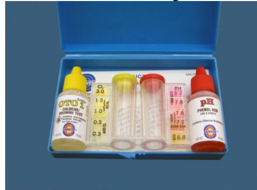
FOTO 14 Test kit Medidor de pH y cloro en el agua
