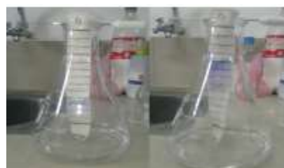
Figura 1 Prueba de absorción vertical Bambú Vs Algodón.
