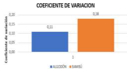
Figura 9 Valores comparados de la cantidad de agua evaporada en el proceso de secado en algodón y bambú mediante el coeficiente de variación.
