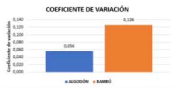
Figura 5 Valores comparados del índice de absorción de humedad en algodón y bambú mediante la media. Prueba #1.
