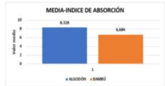
Figura 4 Valores comparados del índice de absorción de humedad en algodón y bambú mediante la media. Prueba #1.
