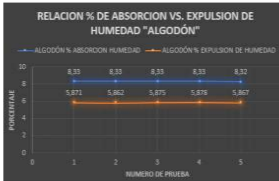
Figura 10 Relación % de absorción de humedad Vs. % de expulsión de humedad en fibras de Algodón.
