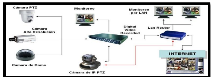
Figura 1. Esquema básico de un sistema de video vigilancia IP.
