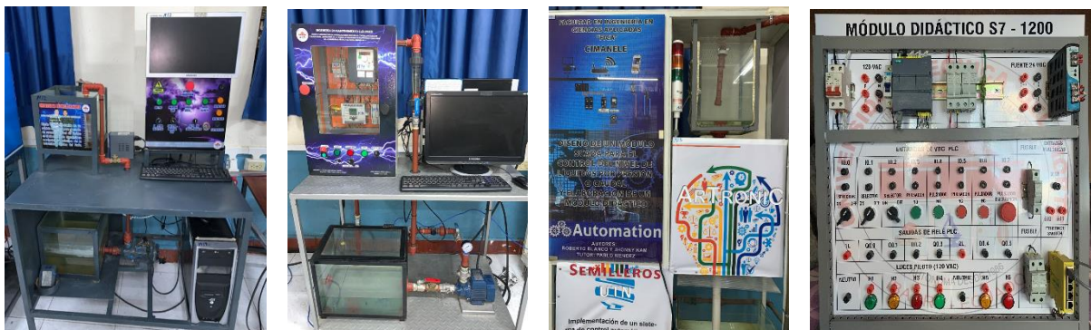
Fig. 6. 1 Módulos que conforman el sistema SCADA
