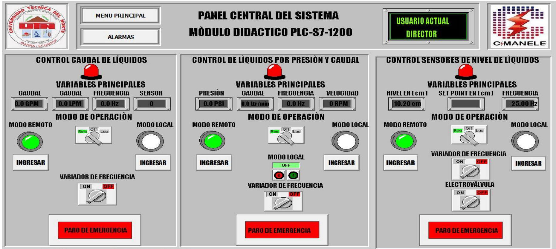
Fig. 51 HMI final módulo PLC S7-1200
