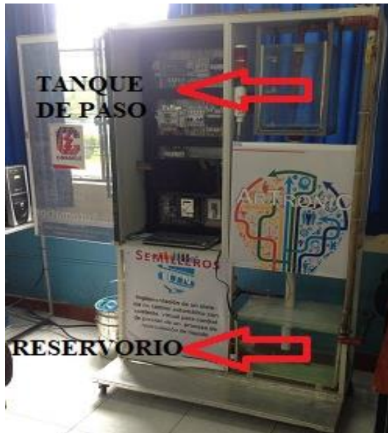
Fig. 27 Tanque de paso y Reservorio de Agua
