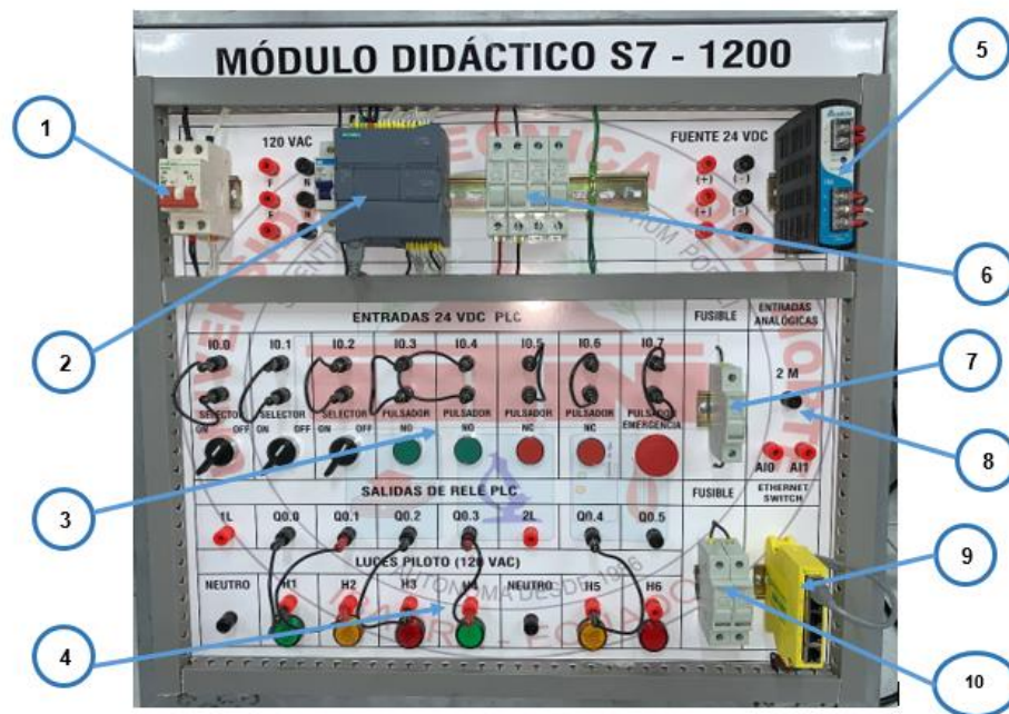
Fig. 3. 2 Modulo didáctico PLC S7-1200
