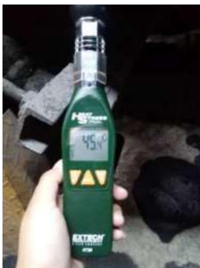
Figura 10 Medición área de generación de vapor. El Autor
