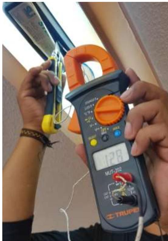
Medición de niveles de temperatura (°F) en los balastos de las luminarias fluorescentes
