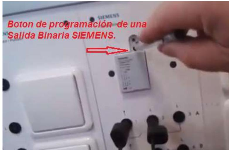
*Fig. 12 Ubicación del pulsador de programación de una salida Binaria SIEMENS (Sáenz, 2016)*
