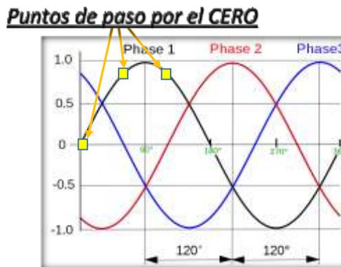
Fig. 9 Señales Sinusoidales de un sistema trifásico (El Autor, 2018)
