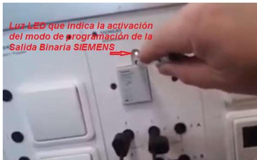
*Fig. 13 Encendido del Led de programación de una salida Binaria SIEMENS (Sáenz, 2016)*
