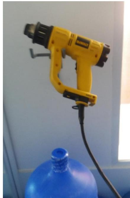
Fotografía 11: pistola de calor para el etiquetado
