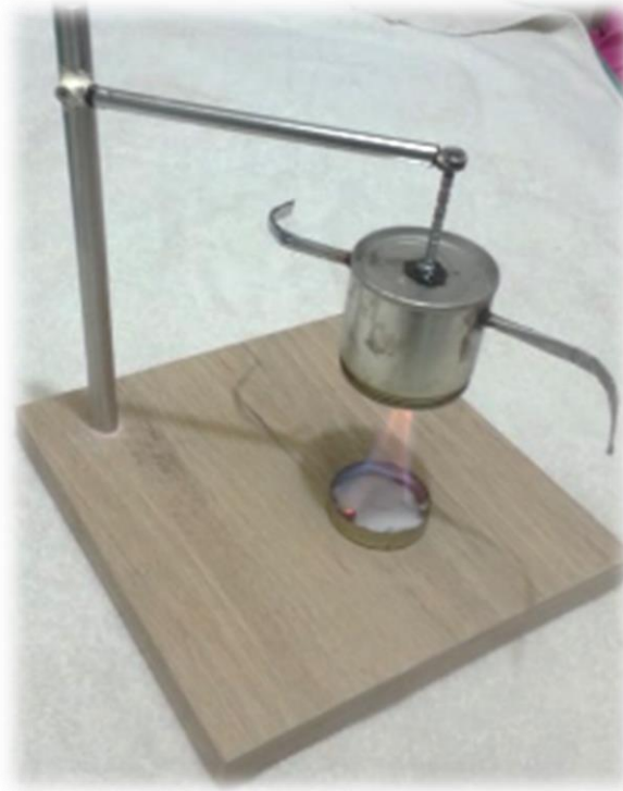
Figura 2: Eolipila de Herón Fuente: Fotografía tomada por la autora Elaborado por: La autora
