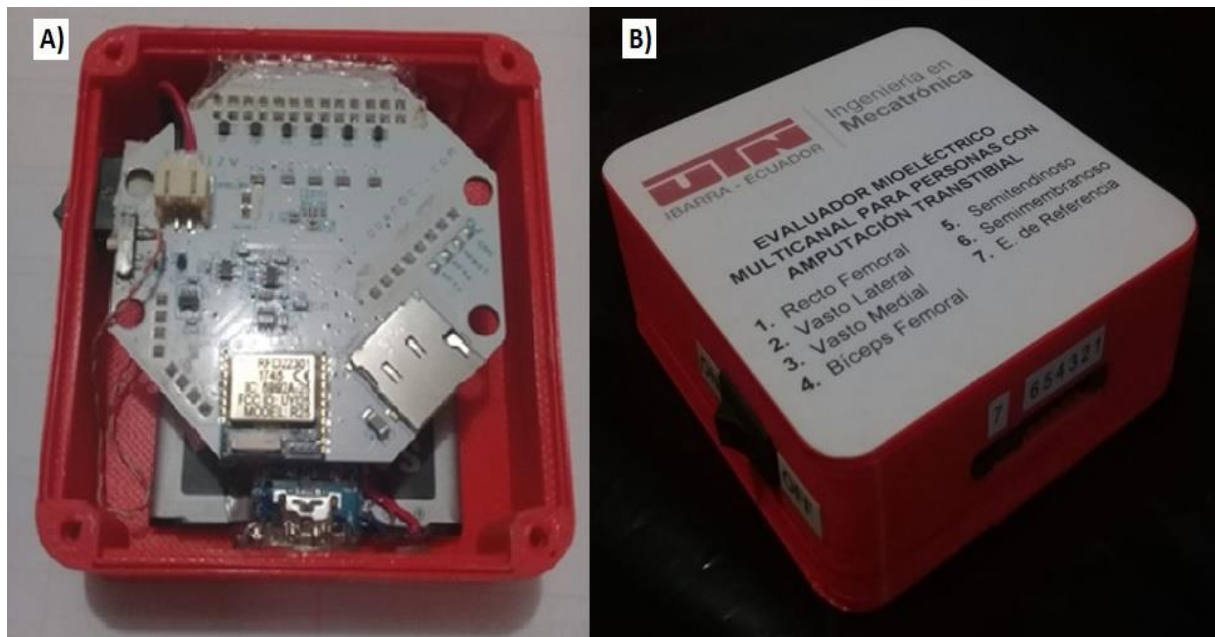
Figura 3.2. Evaluador mioeléctrico multicanal. A. Vista interna. B. Vista isométrica.
