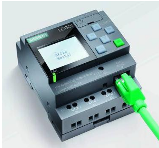
Fig. 11. Controlador lógico programable_ LOGO! 8 (Siemens)
