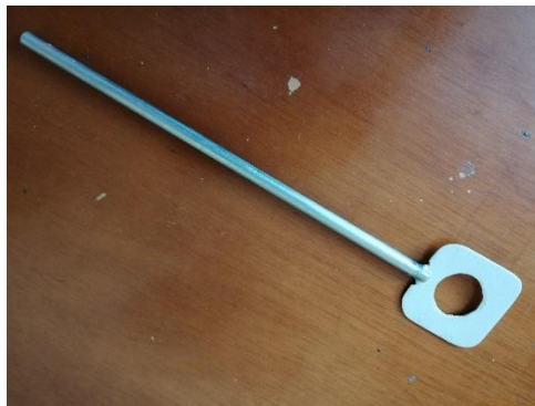
Fig.44. Eje para empotrar sensor capacitivo. Fuente: El Autor.
