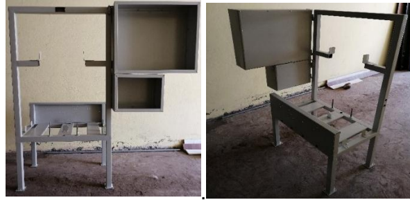
Fig. 46 Estructura en pintura electrostática.
