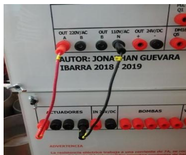
Fig. 64 Conexión motor y resistencia – directo a la fuente Fuente: El Autor
