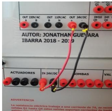
Fig. 66 Conexión 24 Vdc – Tablero secundario Fuente: El Autor
