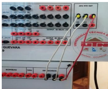
Fig. 62 Conexión del sensor PT100 Fuente: El Autor
