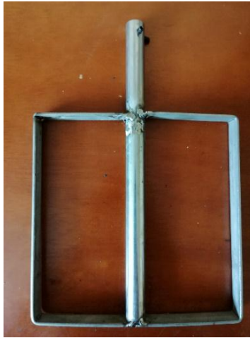
Fig. 41. Aspas del agitador. Fuente: El Autor
