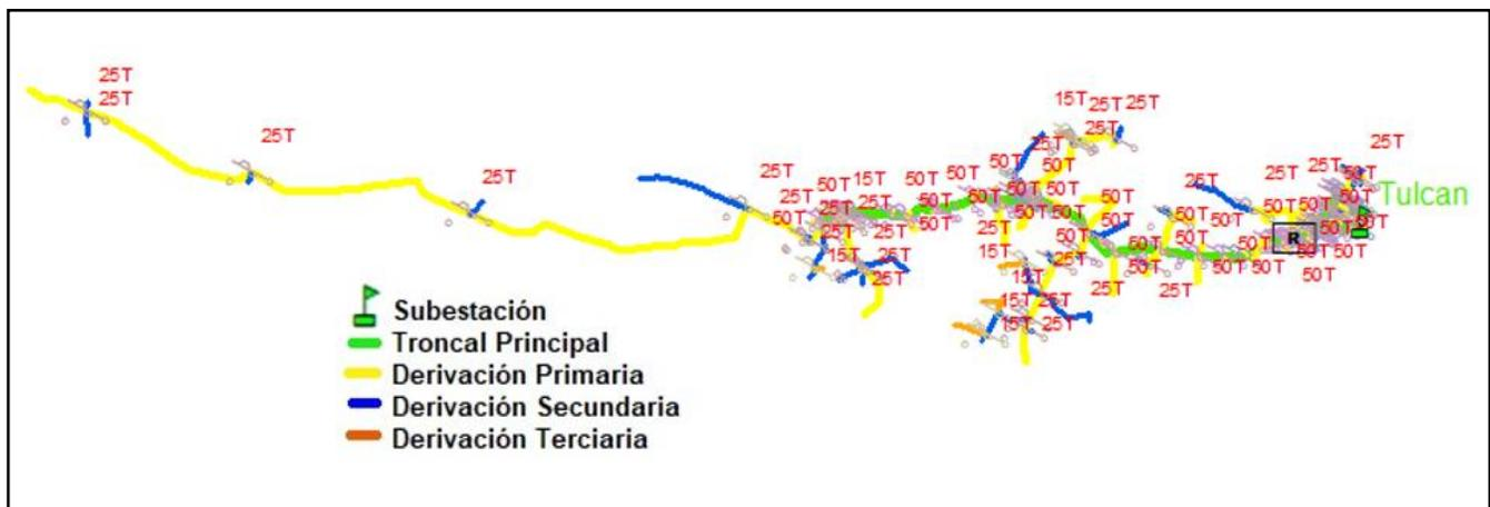
Fig. 58. Esquema de equipos de protección coordinados del alimentador L4.
