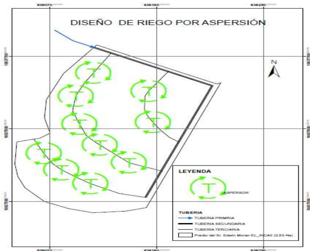
En el mapa se describe el diseño del predio georreferenciado en campo perteneciente al Sr. Edwin Moran de la comunidad el Inca con una superficie de 2,53 ha, y en la leyenda se describe los materiales (tubería y aspersores) de los cuales está compuesto este sistema de riego por aspersión y su distribución en el terreno.
