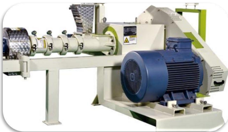
Figura 5. Estructura del extrusor de un solo tornillo. (Bressani, 2016)
