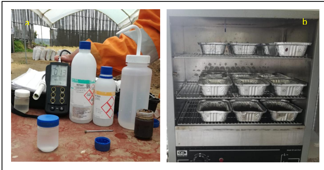
Figura 7. Instrumentos y equipos utilizados (multiparámetro HANNA HI-9813-6 y estufa secadora).
