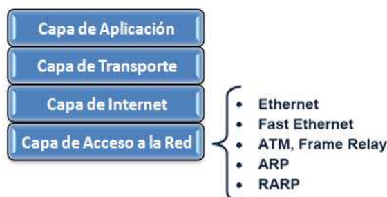
Figura 1.36 Protocolos de Capa Acceso a la Red
