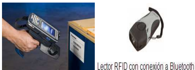
Figura 1.20 Ejemplos de Lector RFID con Antenas Móviles
