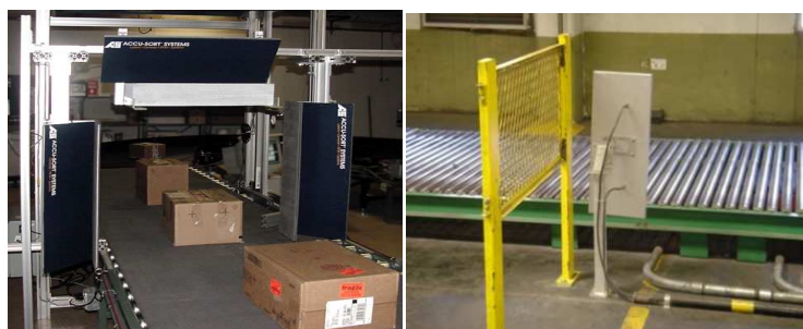
Figura 1.21 Ejemplos de Lector RFID con Antenas Fijas
