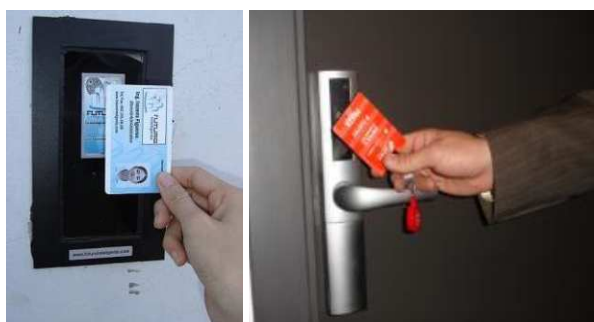
Figura 1.29 Control de acceso con RFID
