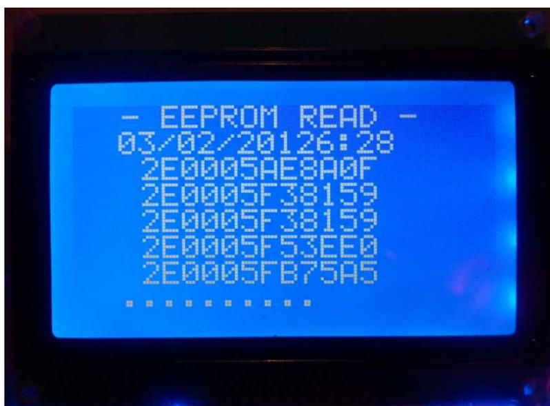
**Figura 4.53** Mensaje en pantalla GLCD indicando que se recupero códigos RFID almacenados en memoria EEPROM del microcontrolador
