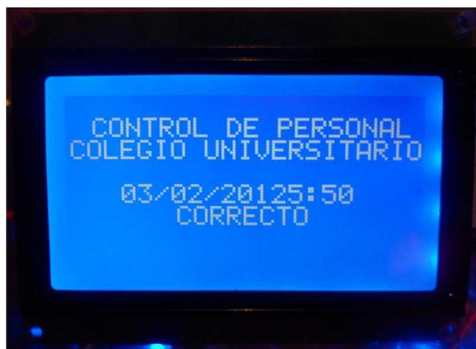
**Figura 4.50** Mensaje del microcontrolador mediante pantalla GLCD indicando que el usuario se ha registrado correctamente
