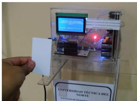
**Figura 4.11 Pruebas de distancia de lectura entre las etiquetas y el lector RFID**
