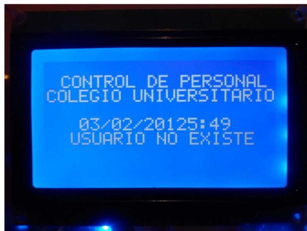
**Figura 4.48 Mensaje del microcontrolador mediante pantalla GLCD indicando que el usuario no existe en la base de datos**
