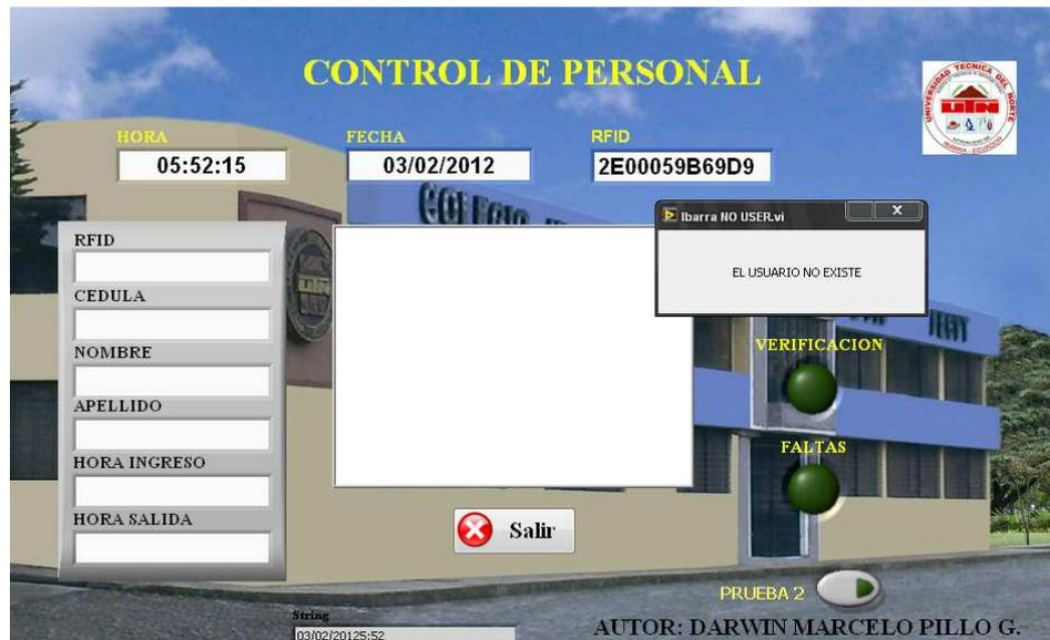
**Figura 4.49** Mensaje del HMI del sistema de control de personal indicando que el usuario no existe en la base de datos
