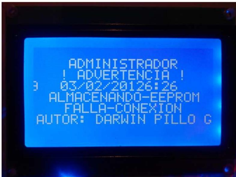
**Figura 4.52** Mensaje en Pantalla GLCD indicando que se encuentra en modo de almacenamiento de código RFID en memoria EEPROM del microcontrolador
