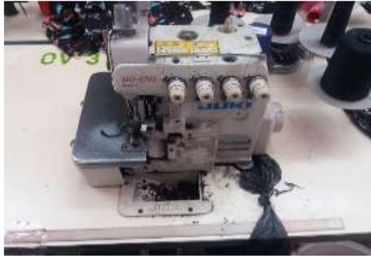
*Figura 7. Máquina Overlock de tres hilos*
