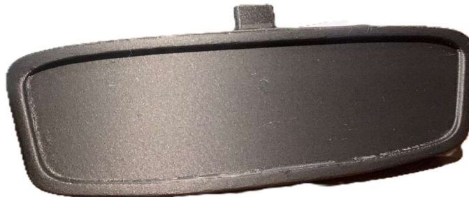
Fig 20. Impresión en fibra de carbono retrovisor interno Ford Bronco 1987
