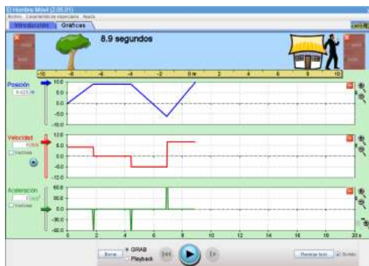
Figura 5. Gráficas posición-tiempo y velocidad-tiempo generadas en el simulador PhET “El Hombre Móvil”. Fuente: PhET Interactive Simulations.
