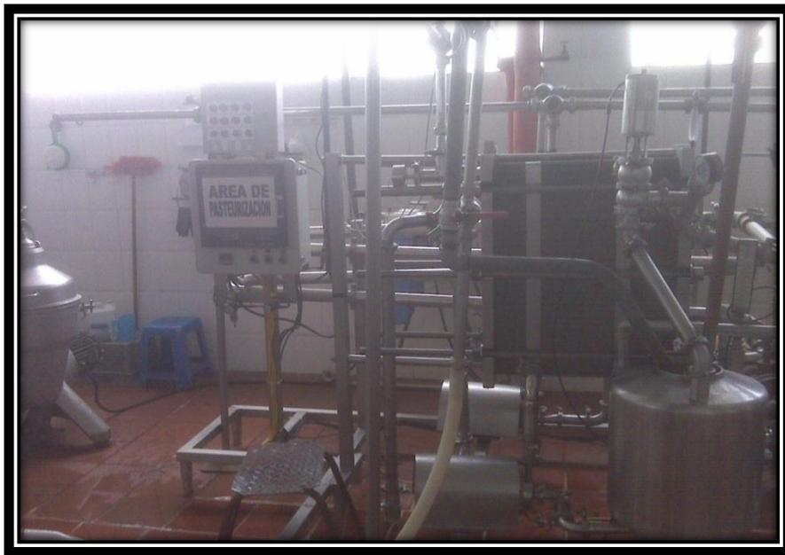
**Figura 2.4.** Equipo de pasteurización PROFLOW
