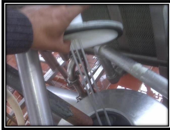
**Figura 3.5.** Control de Nivel por electrodos
