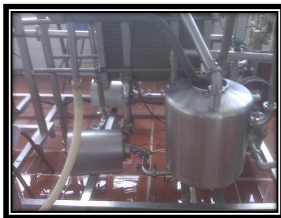
**Figura 3.4.** Tanque de almacenamiento temporal del producto
