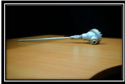
**Figura 1.2.** Sensor PT100 de temperatura
