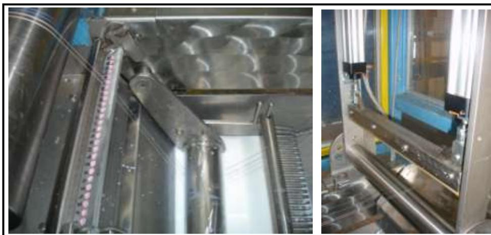
Figura 5.13. Tina de bonding y exprimidor
