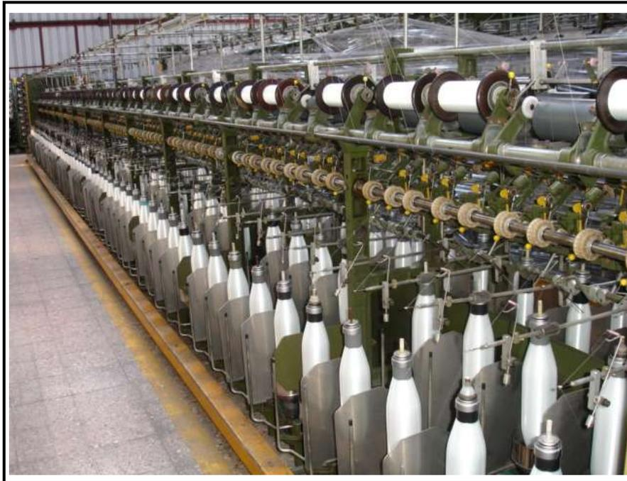
**Figura 4.4. Máquina para primer paso de retorcido**
