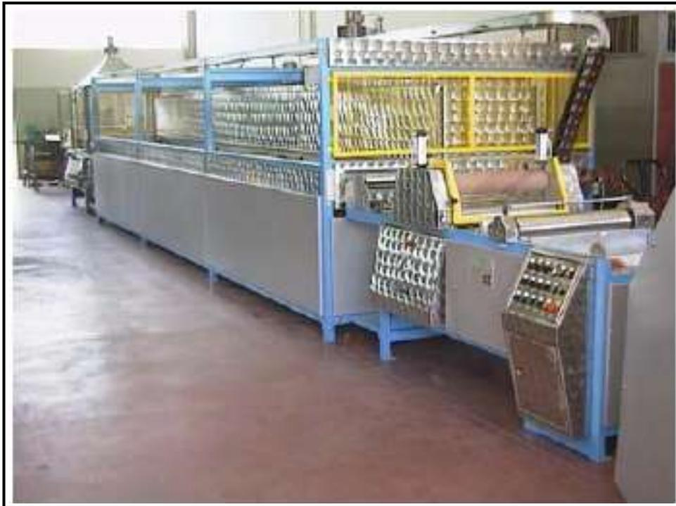
**Figura 4.25. Máquina bondeadora de tres hornos**
