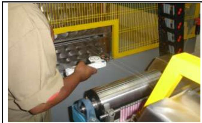
Figura 5.18. Control de tensiones
