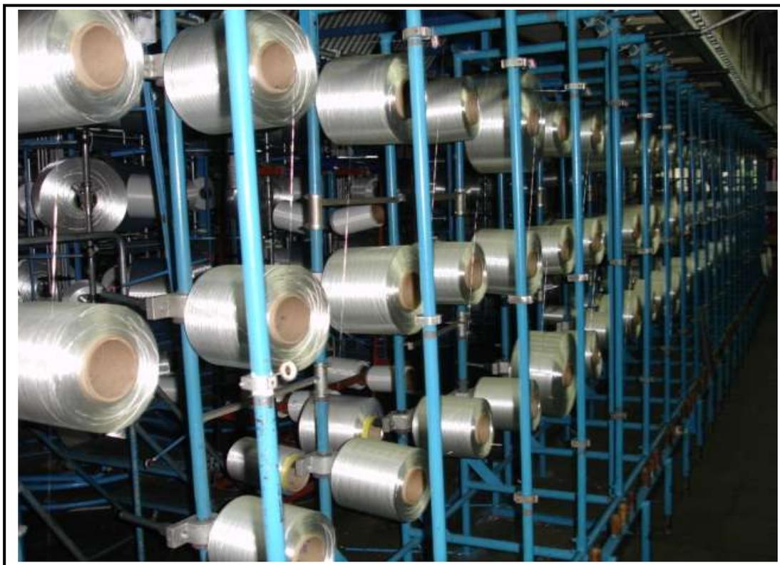
**Figura 4.1 Creel o fileta de alimentación de máquina encapsadora**
