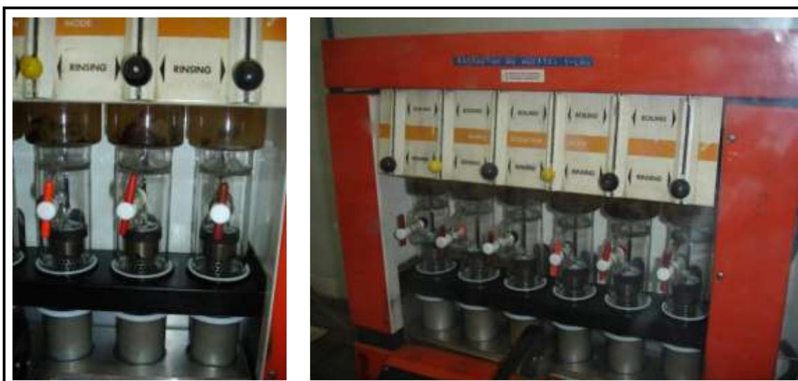
Figura 2.4. Equipo soxtec para extracción de aceite
