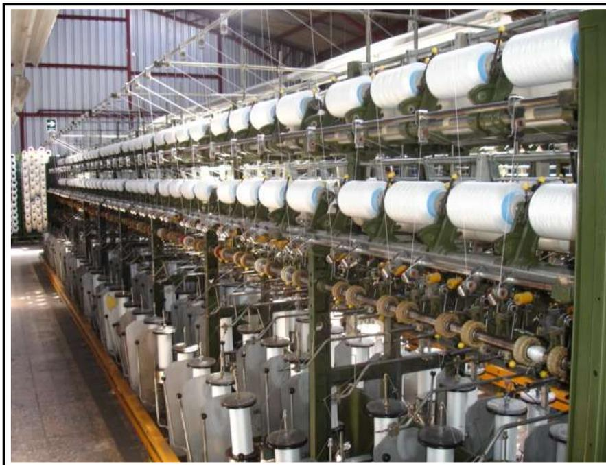
**Figura 4.5. Máquina para segundo paso de retorcido**
