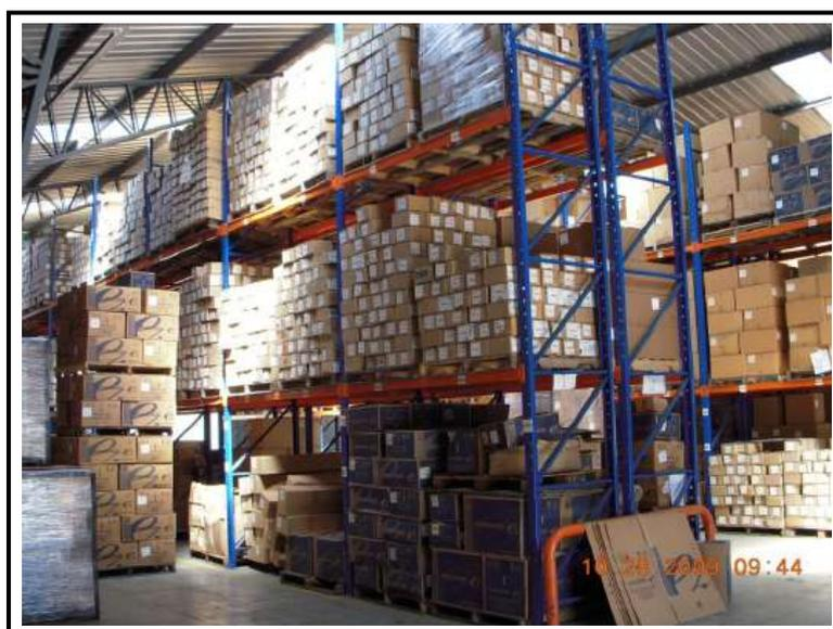
**Figura 4.38. Sistema de almacenamiento en racks**
