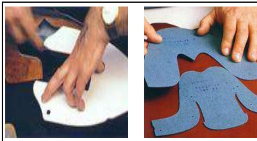
**Figura 1.11. Trazo y corte de las partes del zapato.**
