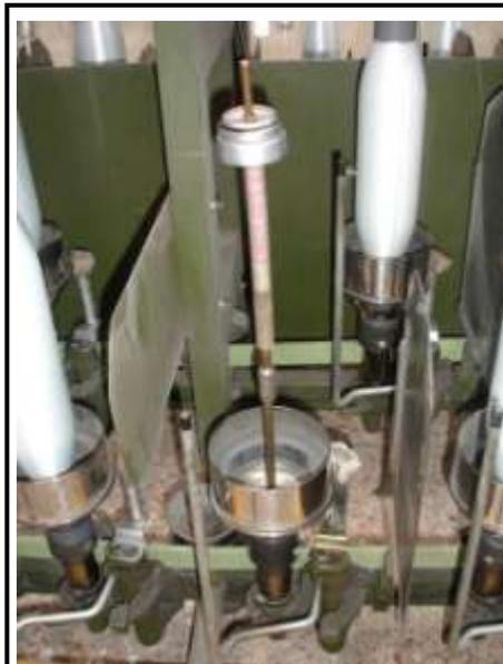
Figura 4.3. Olla, huso, conjunto tensor de máquina retorcidora
