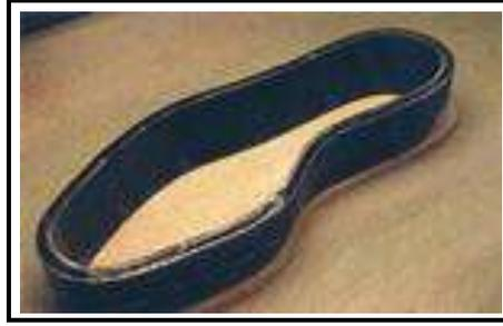
**Figura 1.9. Elaboración de la plantilla de un zapato.**
