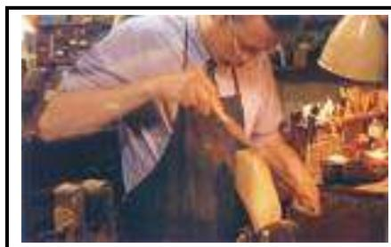
Figura 1.8. Elaboración de la horma de un zapato.
