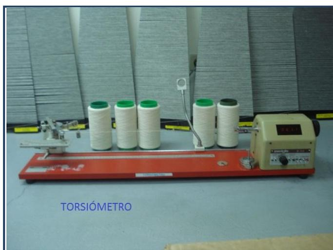
Fig. 44 Torsiómetro
