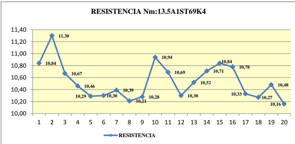
**Fig. 130** Análisis de Resistencia (CN/Tex) del hilo Open end Nm: 13.5A1ST69K4
