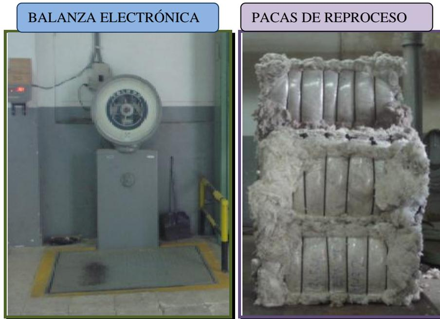
**Fig. 85 Balanza electrónica para pesar pacas de desperdicios**
