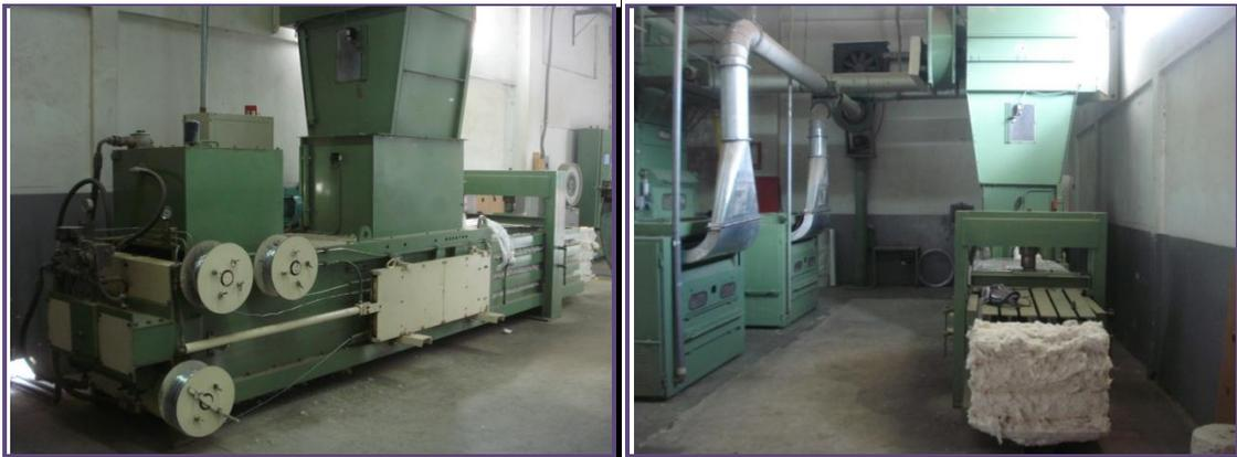
**Fig. 89 Prensa de balas de reproceso**
