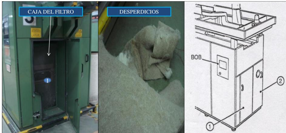
FIG. 37 Caja del filtro para desperdicios
