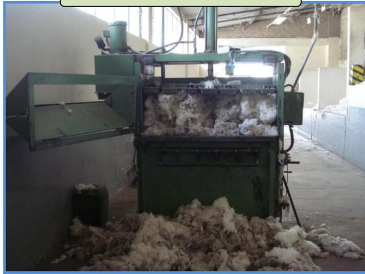
**Fig. 84 Empacadora de desperdicios**
