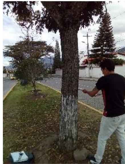
Ilustración 4. Obtención de muestras con el Barreno de Pressler
