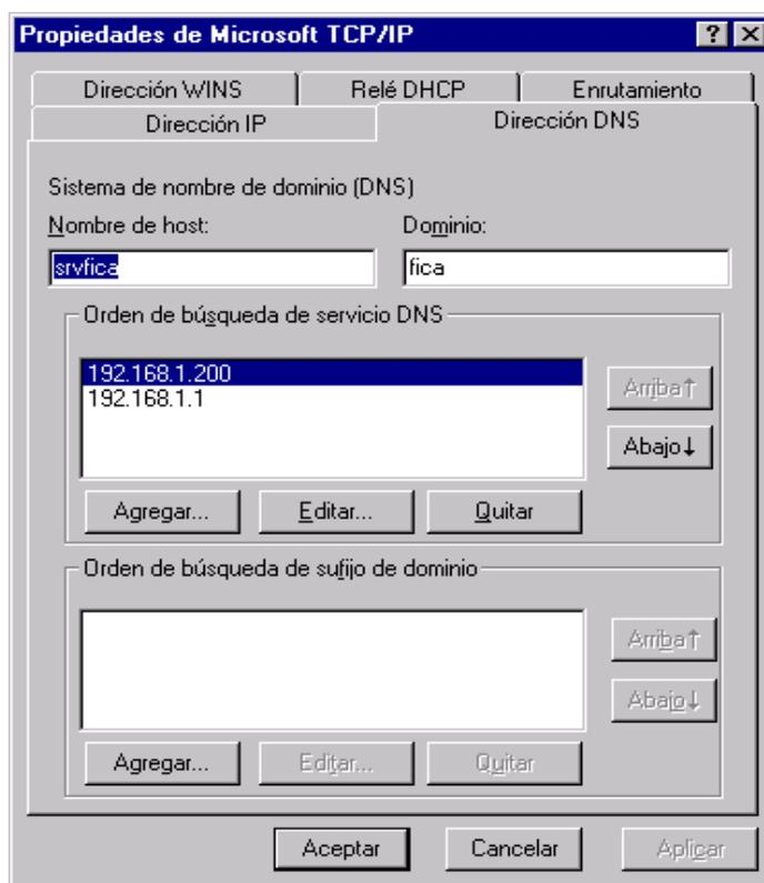
Figura 3: Configuración del cliente del DNS
