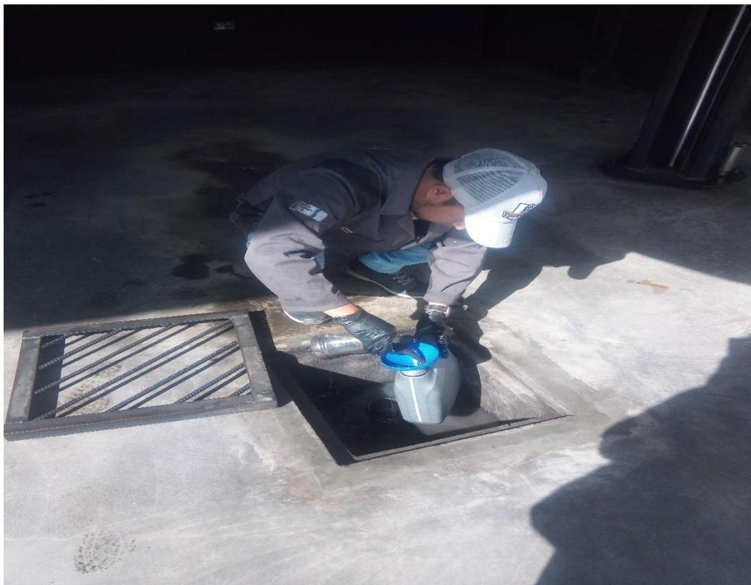
**Figura V.3** Toma de la muestra requerida de agua residual
