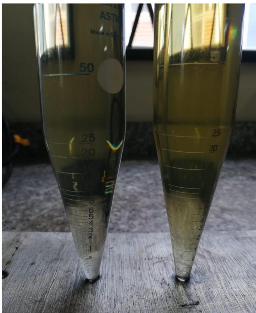
**Figura 3.4** Cantidad de agua y sedimentos en el aceite usado BSW
