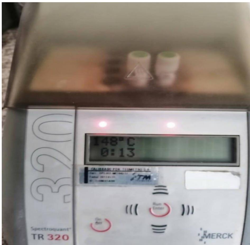
**Figura 3.5** Ensayo de la demanda química de oxígeno en el agua DQO
