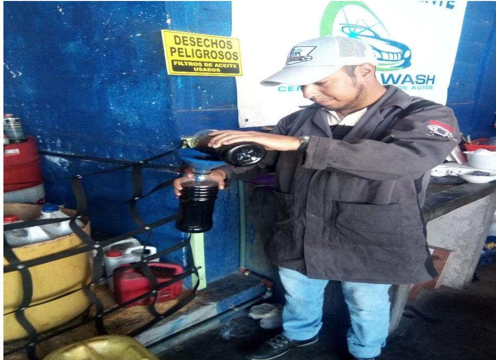
**Figura V.1** Toma de la muestra requerida de aceite usado
