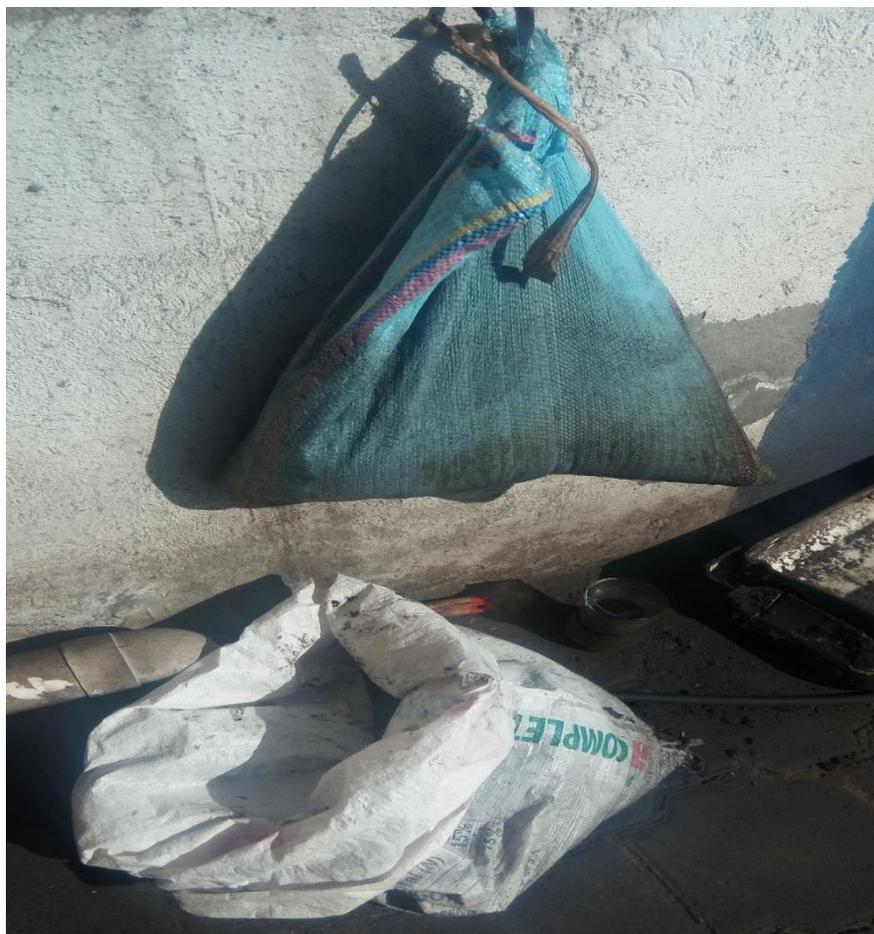
**Figura 4.12** forma de secado y colado del lodo residual
